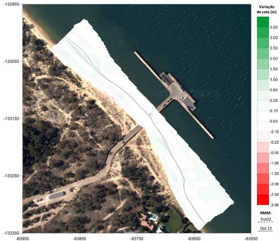
Figura 25. Variações volumétricas no troço costeiro envolvente do novo cais dos ferries, com a linha de costa (nível médio do mar - NMM) sobreposta: outubro de 2022 (linha tracejada); outubro de 2023 (linha contínua). (Sistema PT-TM06/ETRS89, sobre ortofotomapa da dg Território, de 2018).
