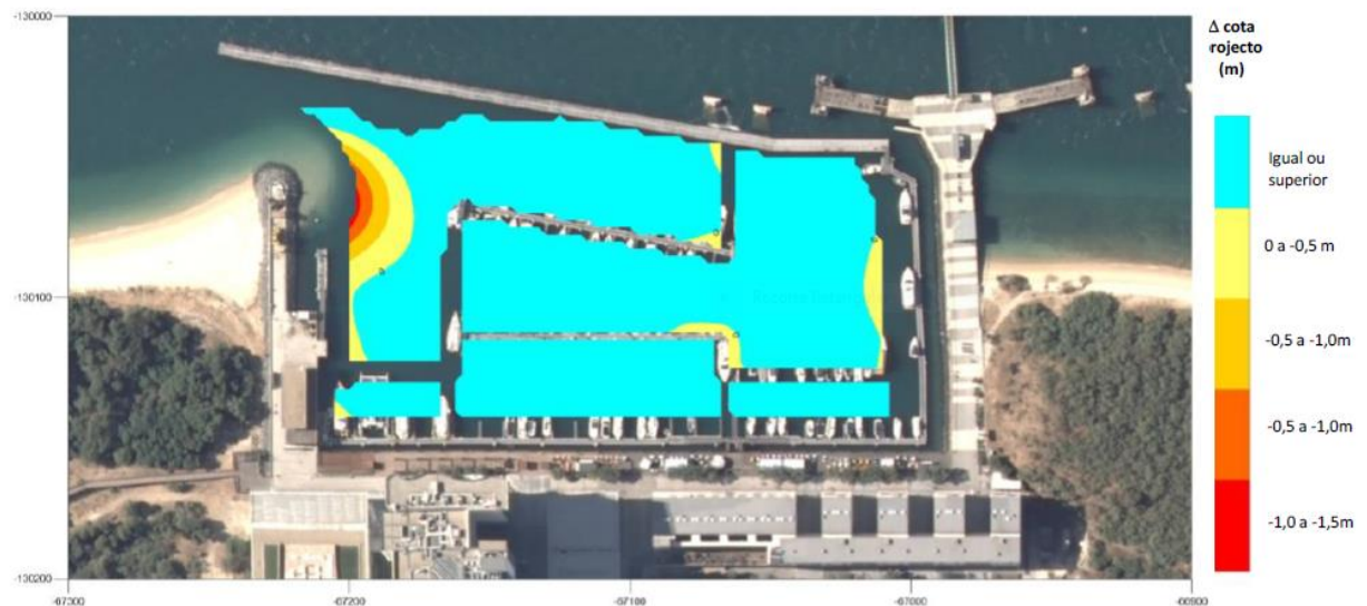
Figura 26. Marina de Troia: Batimetrias (24/03/2024) em relação aos valores de projeto. A azul, profundidades iguais ou superiores às de projeto; amarelos a vermelhos, perda de batimetria em relação ao projeto. (Sistema PT-TM06/ETRS89, sobre ortofotomapa da dg Território, de 2018).
